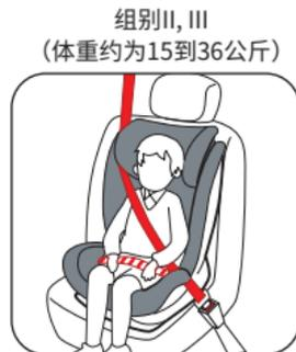
3. APRAMO EROS™ 安全座椅只能被安装在装备有通过ECE R16、GB14166或同等标准认证的三点式安全带的汽车座位上，严禁将安全座椅安装在只装备有二点式安全带的汽车座位上。
