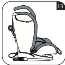
2.3.3 将儿童安全座椅的两个ISOFIX接口 (18) 对准汽车ISOFIX固定装置, 并插入, 直到听到“滴答”声, 此时ISOFIX指示器变绿, 表示两侧ISOFIX接口 (18) 已经锁定。
