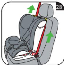
**注意：车用安全带腰带（23）必须经过两侧GI安全带导向件（07）。**
